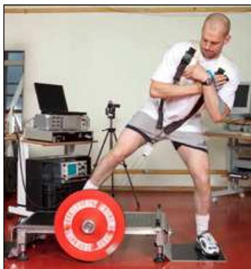
Máquina yo-yo para realizar trabajo excéntrico
